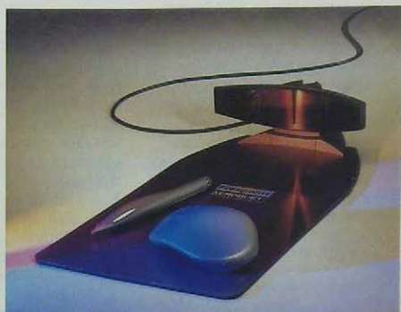
Набор AeroDuet фирмы Creative: беспроводные мышь и перо для связи с настольным приемным устройством используют ИК-лучи.
