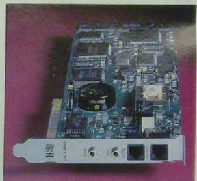
Одновременно беседовать по телефону и передавать данные — именно это позволит вам DSDV-модем фирмы U.S. Robotics.
