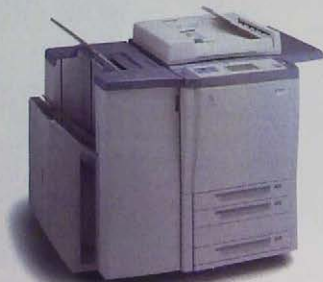
С помощью цифрового интерфейса цветной лазерный копировальный аппарат, подобный показанному на рисунке Xerox Regal 5790, превращается в принтер.
