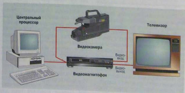
Схема комплекса для видеоредактирования. Залог успеха домашней видеостудии — правильное соединение всех компонентов. Обычно ПК используется для управления редактированием исходной ленты, воспроизводимой на видеомангифоне. Видеокамера нужна для просмотра редактируемой ленты, а телевизор — для просмотра результата.
